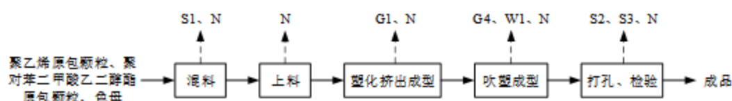
图 2-5 塑料花盆生产工艺流程及排污节点图
